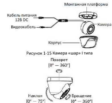
Рисунок 1-16 Настройка угла наблюдения камеры
